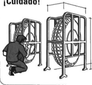
Durante las operaciones de preinflado e inflado final, las llantas deberán estar en una jaula de protección a fin de evitar cualquier accidente durante el procedimiento. En caso de que no sea posible utilizar una jaula, evite colocarse en la trayectoria que los elementos del aro/rin tomarían si se presenta una explosión. El desmonte debe realizarse con la llanta totalmente desinflada, teniendo especial cuidado al desencajar los talones del rin, para no dañarlos.
